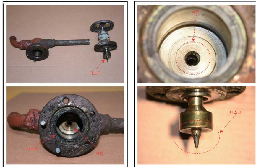
상: 밸브 보닛을 개방하여 내측을 검사한 형태 하: 밸브 가스켓에 원치한 파손이 없는 상태
