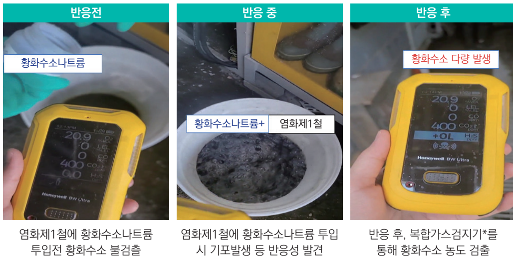
<표 9> 염화제일철과 황화수소나트륨의 혼합 반응 실험 결과
